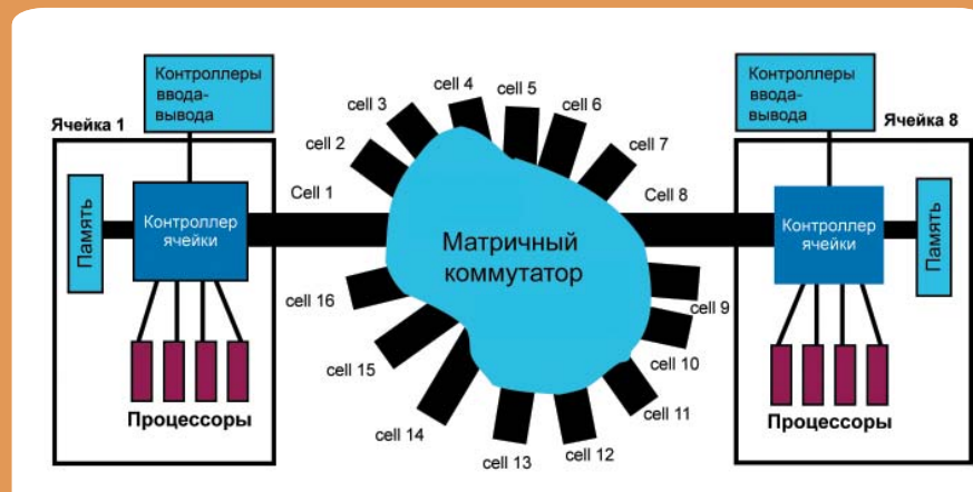
Рис. 1. Архитектура на основе ячеек
